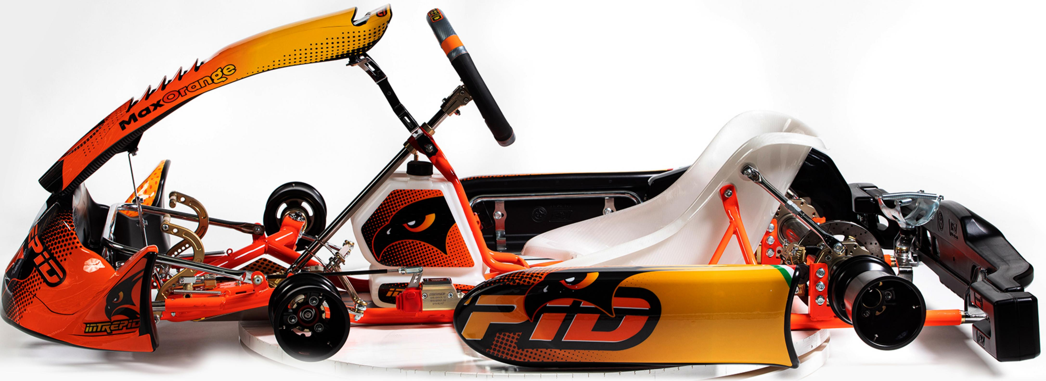
**DESCRIZIONE TELAIO:** Il telaio MATRIX, è un mezzo altamente performante ed idoneo alle piste con poco grip, grazie alla particolarità della scocca composta da tubi di Ø30 esclusa la traversa posteriore composta da tubo di Ø32. Idoneo per le categorie: OK, OK JUNIOR, OKN, OKN JUNIOR e tutte le categorie monomarcia.
